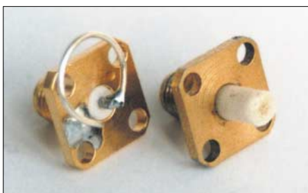
Bild 8: Die verwendeten Proben zur Signaleinkopplung sollten isoliert oder galvanisch mit Masse verbunden sein.
