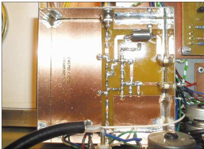
Bild 1: Die Abschwächerbaugruppe, hier ein Vorgängermodell mit größerer Platine, kann innerhalb des softwaregesteuerten Messplatzes oder als separate Einheit betrieben werden.
