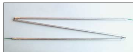
Einige der je 6 mm starken Silberröhren der Antenne von A-Sat 137
